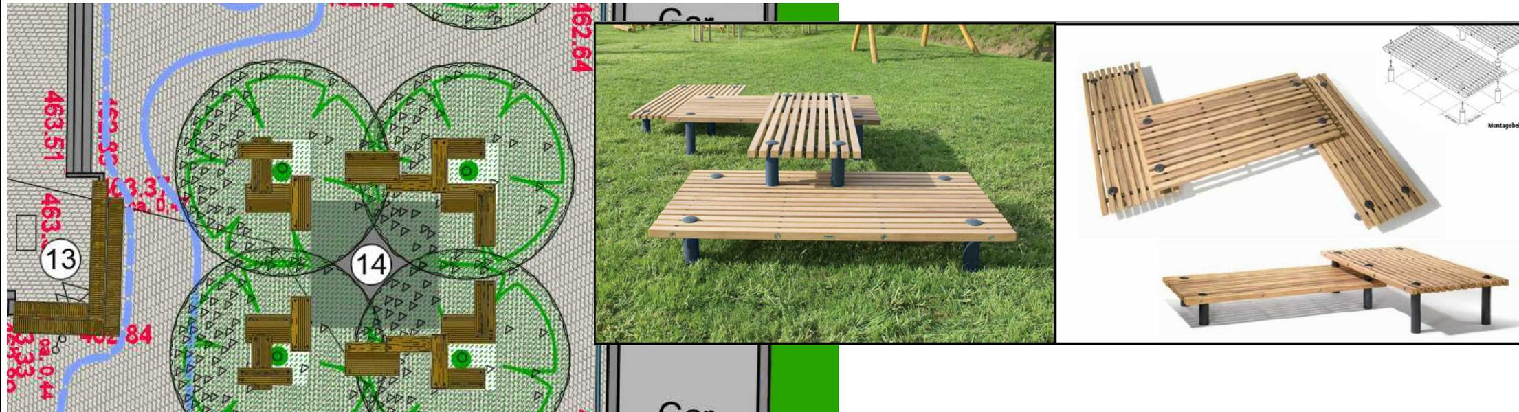
b) individuelle Podest-Konstruktionen im Bereich der einzelnen Bestandsbäume bzw. eine zusammenhängende, großflächige Podest-Konstruktion mit Terrassendielen aus Lärche.
